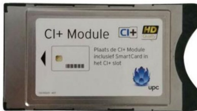
Abbildung 4.1 Ein CI+-Endkundenmodul: bis zu zwei Dienste gleichzeitig. Produktfoto: Drittanbieter
