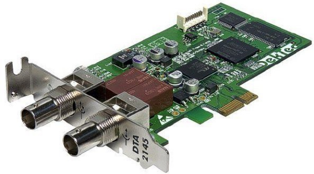
Abbildung 12.7 Analysator als PC-Karte. Produktfoto: DekTec
