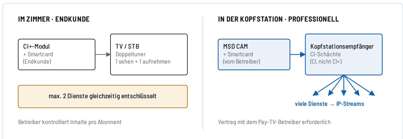
Abbildung 4.2 Ein CI+-Endkundenmodul entschlüsselt höchstens zwei Dienste, ein professionelles MSD-CAM im Kopfstationsempfänger viele.
