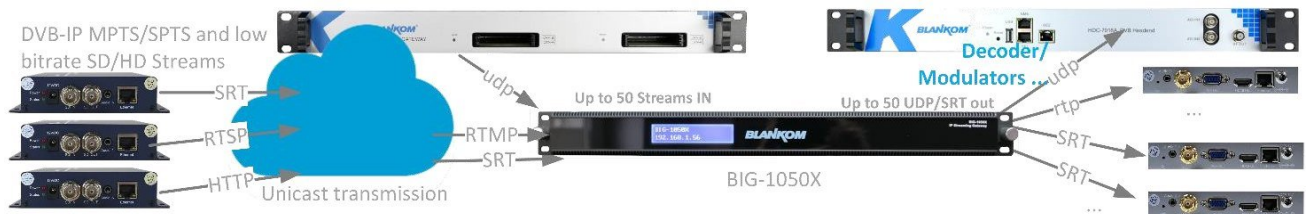
Abbildung 17.3 BIG-1050X setzt SRT-, RTSP-, RTMP-, HTTP- und UDP-Streams um, Unicast wie Multicast, für Decoder und Modulatoren.
