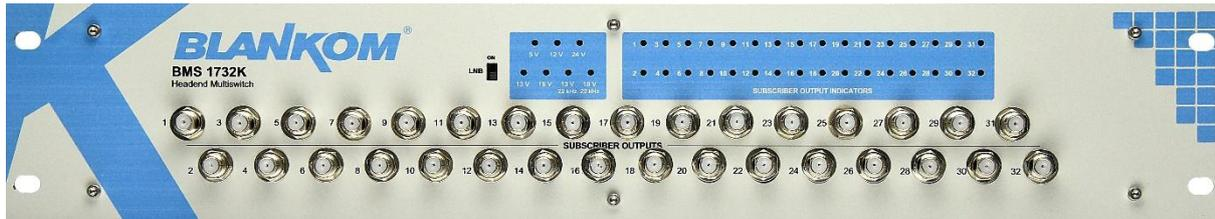
Anm.: Bild hier der 17-32er - der 9-32er hat Hinten 8 Eingänge weniger - der BMS-0932K Multischalter kann zusätzlich noch DVB-T2 per Außenantenne aus der Luft ‚fischen‘ und durch die Ausgangs-Koaxkabel mit durchleiten.
